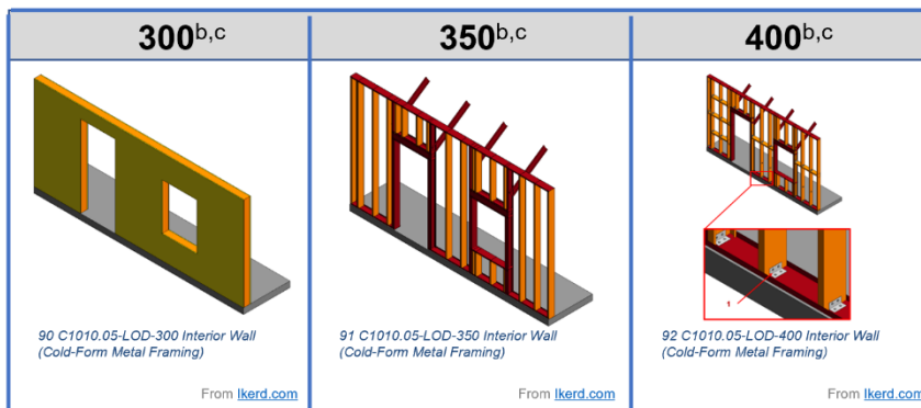
Figura 2: Imágenes de muestra de Cold Formed Metal Framing (CFMF) de la especificación BIMForum Global. Tenga en cuenta que en LOD 350 solo se modelan pernos, mientras que los sujetadores de conexión se incluyen en LOD 400.
